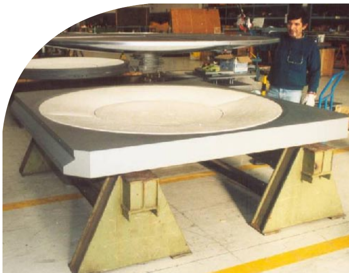
Fabbricazione di appoggi SFERON da 110.000 kN di portata per il Plok Bridge a Warsavia. Fabrication of 110.000 kN capacity SFERON bearings for the Plok Bridge in Warsaw.
