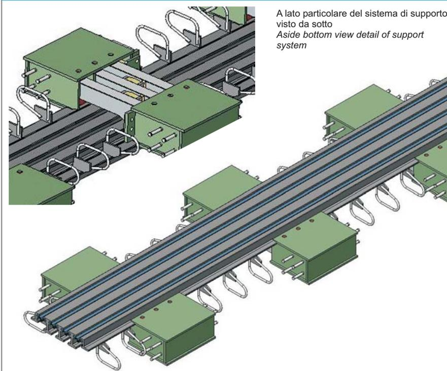
A lato particolare del sistema di supporto visto da sotto
