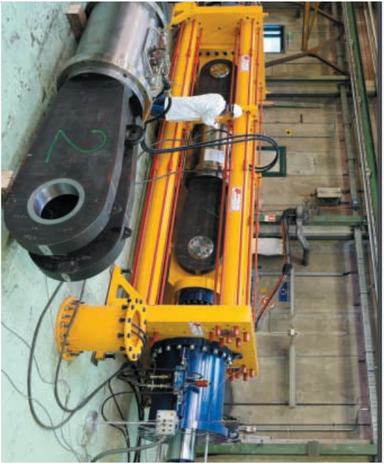
• prove dinamiche su shock transmission units da 8000 kN
