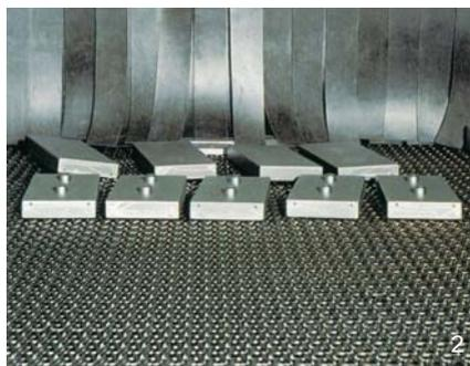
1. Saldatura dei perni e molatura. - Pins welding and grinding.
