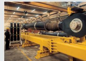
Allentamento della prova su un dispositivo di vincolo dinamico per lo Storebaelt Bridge (Danimarca).
