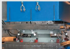
Un isolatore FIP-D durante una prova presso il laboratorio Eucentre a Pavia.
