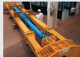
Prove presso il laboratorio FIP su un dissipatore viscoso per il Rion-Antirion Bridge (Grecia).
