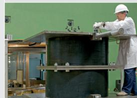
Allentamento presso il laboratorio FIP di una prova sperimentale su due isolatori SI di diametro 1150 mm.
