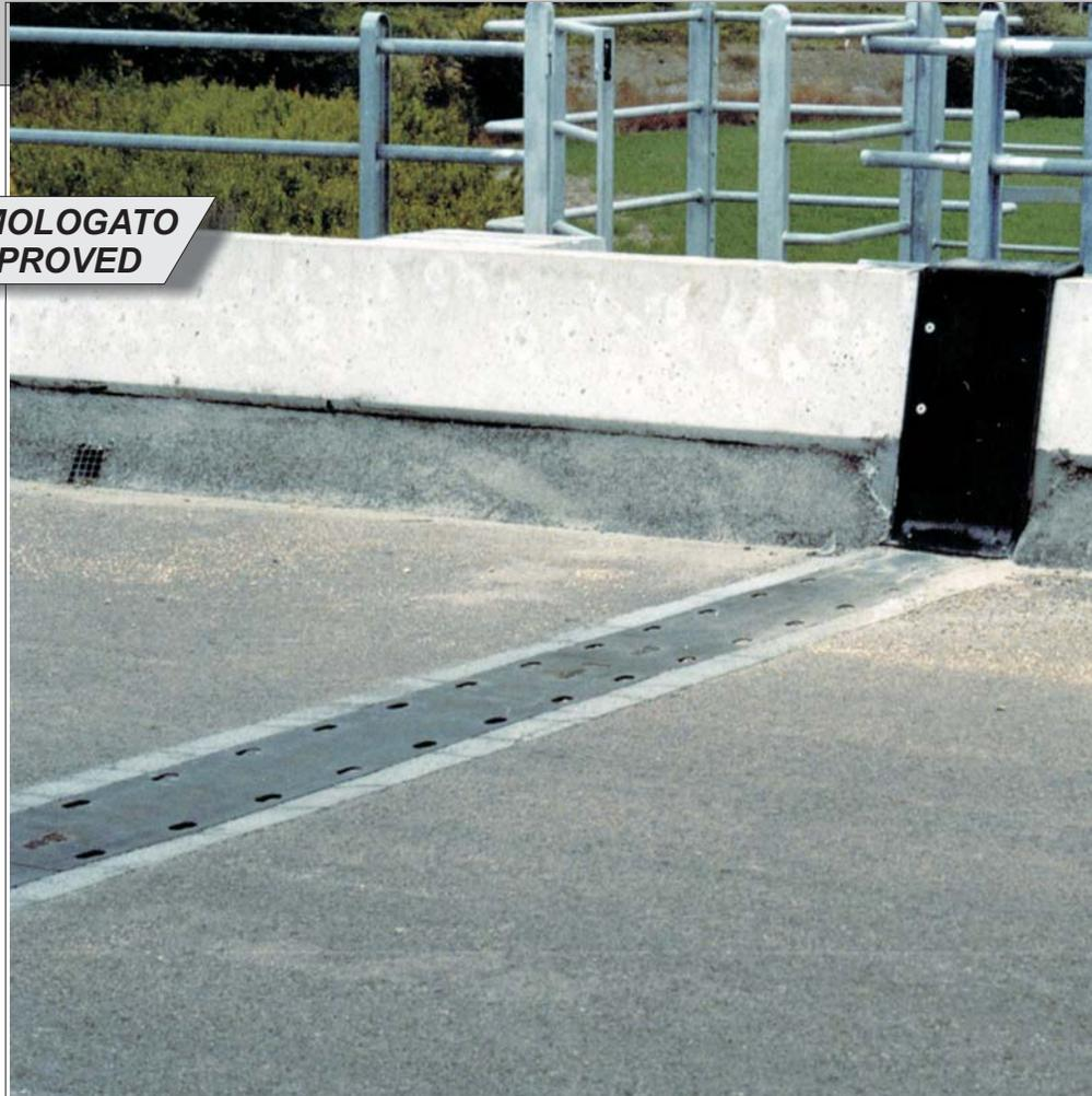
camminamenti laterali consente i movimenti tra le parti strutturali, evita al ballast o a corpi estranei, di entrare nella fenditura e garantisce l'isolamento elettrico. E' possibile, inoltre, modellare, tramite piegatura, la piattabanda contro il cordolo o il muretto para-ballast del camminamento.
