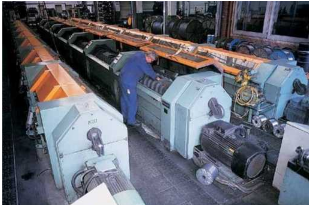
Verseilung eines Seiles Stranding of a cable
